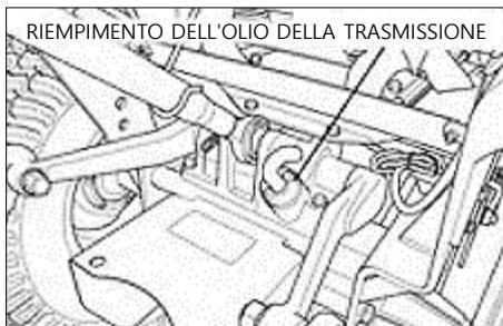
Seguire i passi successivi per sostituire l'olio della trasmissione.
