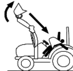
Quando si monta o si smonta il caricatore, fissare tutte le parti collegate alla benna e al braccio.
