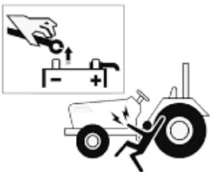
Quando si interviene sui componenti elettrici del trattore, occorre innanzitutto scollegare i cavi della batteria.
