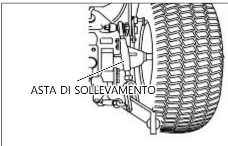
Per applicazioni diverse, modificare la posizione dell'asta della forcella sui fori del braccio inferiore come illustrato e inserire il perno nella direzione della freccia.
