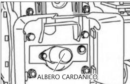
Quando l'albero della presa di forza non viene utilizzato, applicare del grasso e posizionare il relativo cappuccio.
