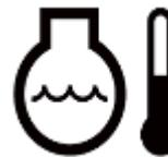
Se la spia del liquido di raffreddamento si accende, il motore è surriscaldato. Arrestare il trattore e controllare quanto segue:
